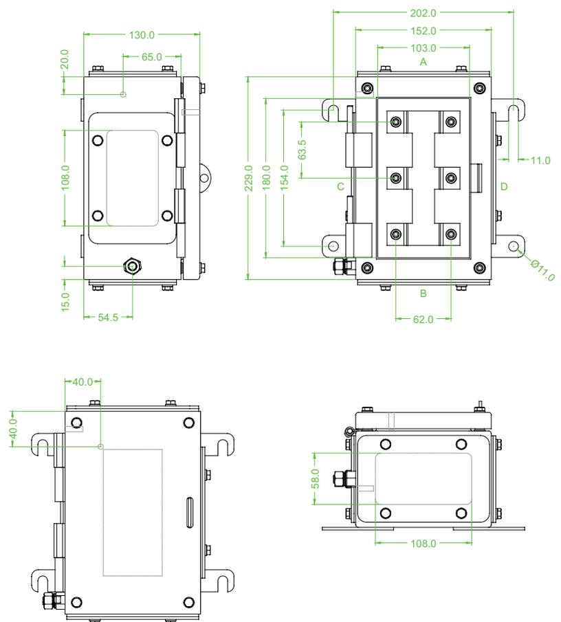
Abbildung/Maßzeichnung zeigt Version mit 4 Flanschplatten.
