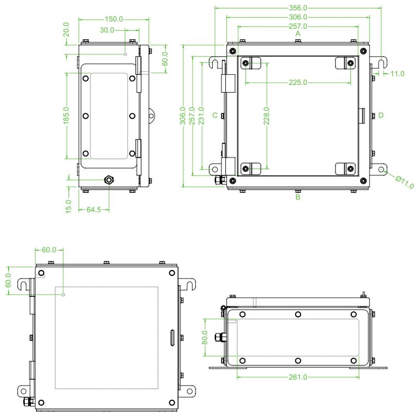
Abbildung/Maßzeichnung zeigt Version mit 4 Flanschplatten.
