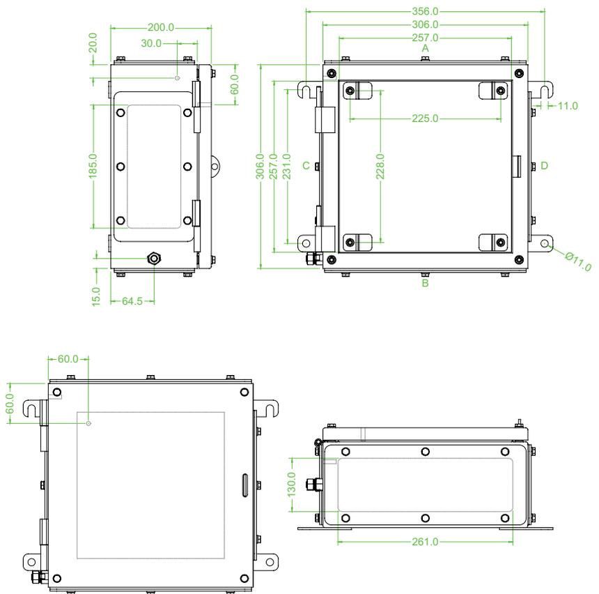
Abbildung/Maßzeichnung zeigt Version mit 4 Flanschplatten.
