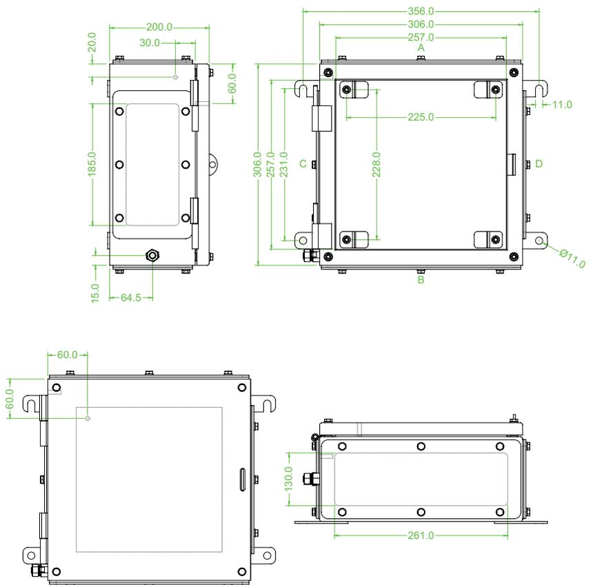
Abbildung/Maßzeichnung zeigt Version mit 4 Flanschplatten.
